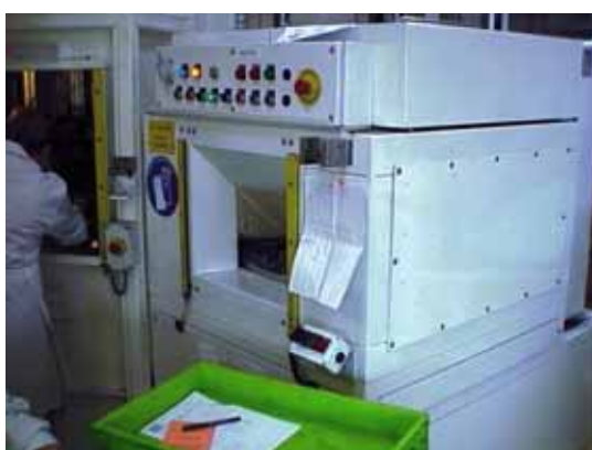
FOUR DE POLYMERISATION sur site
